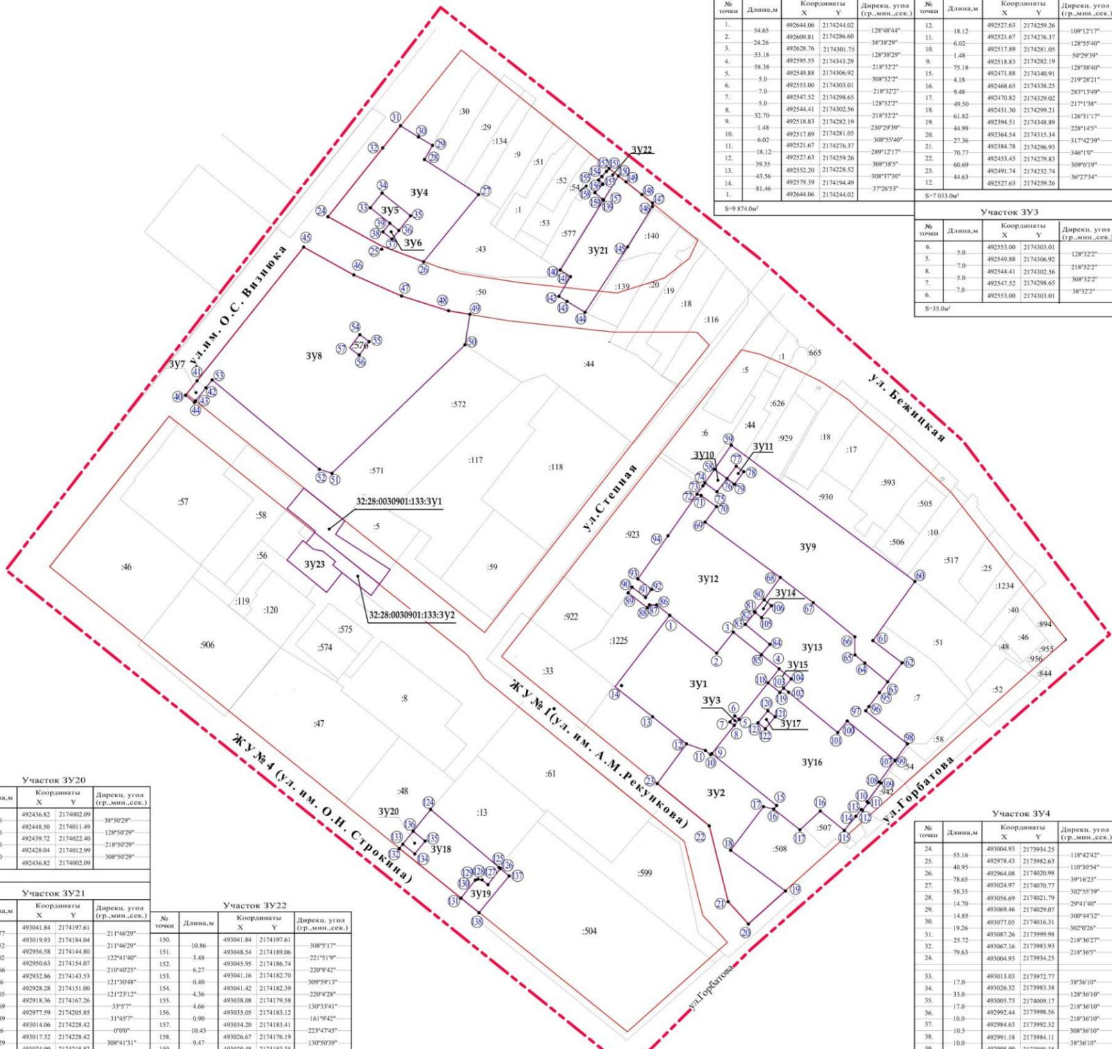
Tables for specific plots: Участок ЗУ20, Участок ЗУ21, Участок ЗУ22, and Участок ЗУ19, listing points, lengths, coordinates, and bearings.
